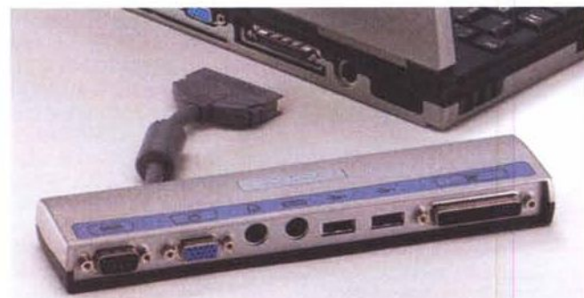
La "docking bar" che replica tutti i connettori presenti sul retro del notebook, da collegare sul connettore proprietario.
